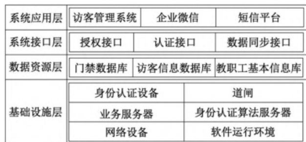
图 3 门禁系统架构
